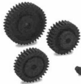
Proposti in tecnopolimero a base poliammidica, rinforzato fibra vetro, in colore grigio, gli organi di trasmissione **Elesa** si dividono in due famiglie: gli ingranaggi cilindrici (angolo di pressione di 20°) a denti dritti (ZCL) e le cremagliere (angolo di pressione di 20°) a dentatura dritta (ZCR). I moduli degli ingranaggi che **Elesa** propone vanno da 0.5 a 3.0 mentre
