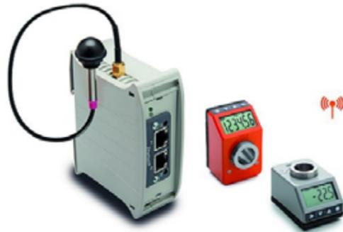
Unità di controllo UC-RF e indicatori di posizione elettronici DD52R-E
